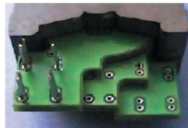
Рис. 3. Использование пакетов печатных плат в планарных трансформаторах
