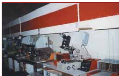
Рис. 7. Установка контактного совмещения и экспонирования ЭМ-576
