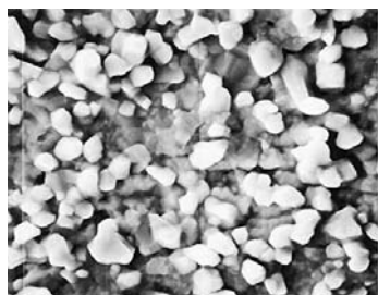
Рис. 2. Покрытие иммерсионного олова на медь без использования органического металла (мелкие, четкие кристаллы; поверхность шероховатая; структура пористая)
