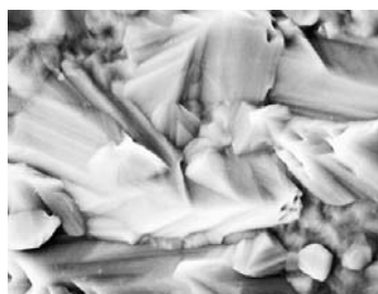
Рис. 3. Покрытие иммерсионного олова на медь с использованием органического металла в качестве барьерного слоя (кристаллическая структура более совершенна; поверхность гладкая; структура плотная)
