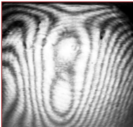
Рис. 8. Лазерная интерферограмма исследуемого п/п кристалла
