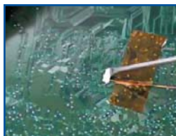
Рис. 4. Установка термопары под BGA с обратной стороны
