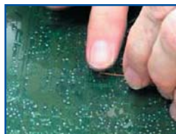
Рис. 3. Установка термопары под BGA с обратной стороны
