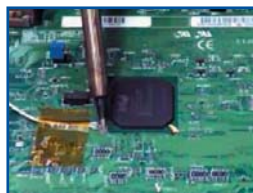
Рис. 6. Фиксация термопары термостойкой лентой с верхней стороны платы
