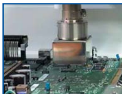
Рис. 4. Установка термопары под BGA с обратной стороны
