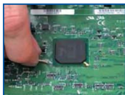
Рис. 5. Фиксация термопары термостойкой лентой с нижней стороны платы
