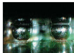
Рис. 6. Дефект плохой смачиваемости
