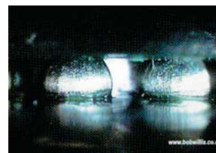
Рис. 5. Типичное соединение BGA сплавом SAC
