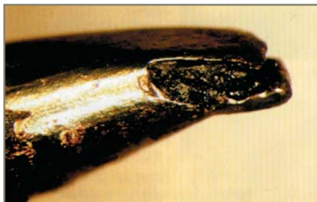
Рис. 7. Поврежденное жало паяльника от использования бессвинцовых припоев
