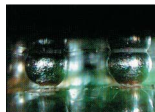
Рис. 6. Дефект плохой смачиваемости
