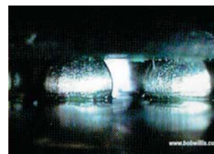
Рис. 5. Типичное соединение BGA сплавом SAC
