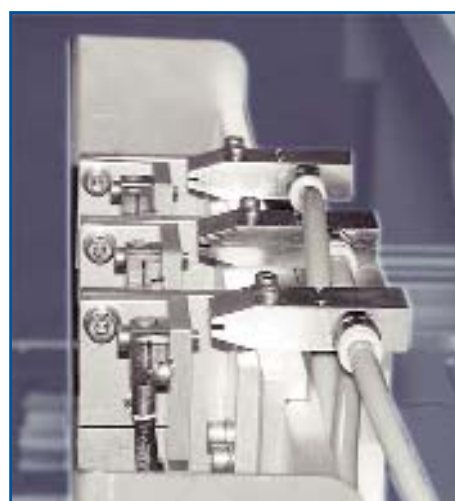
Рис. 8. Функция автоматической очистки форсунок
