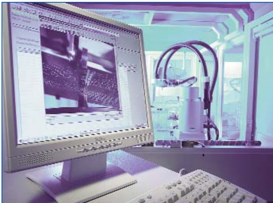
Рис. 4. Системы селективной пайки миниволной с использованием захватов для перемещения обрабатываемых плат
