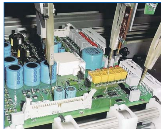
Рис. 1. Принцип работы контактирующего устройства установки SPEA 4040
