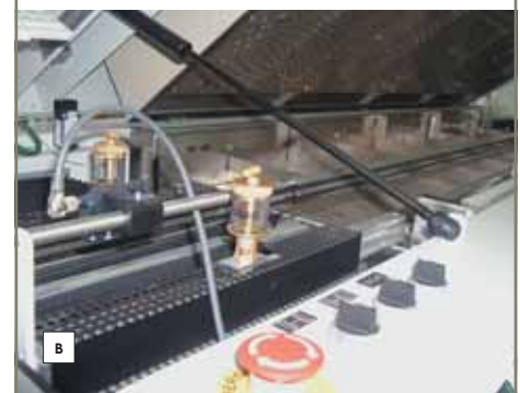
Рис. 2. а) Линия поверхностного монтажа; б) конвейерная конвекционная печь оплавления RO400FC-С; в) цепной конвейер с системой смазки
