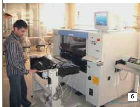
Рис. 4. а) Автомат поверхностного монтажа m4e в составе линии автоматической сборки; б) установка подкатной тележки-базы в автомат (переналадка на новое изделие)
