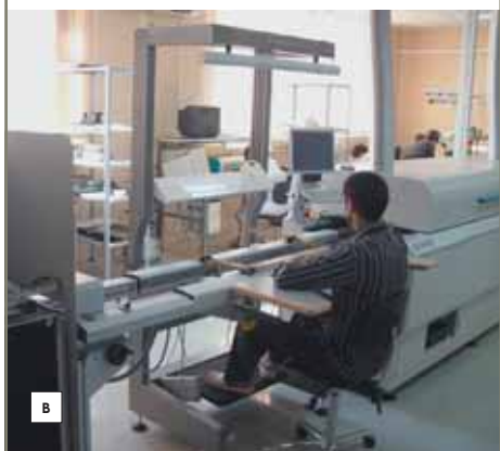
Рис. 3. а) Система автоматической оптической инспекции SAKI; б) ремонтный центр TF1700, в) конвейерный модуль визуальной инспекции и доустановки компонентов
