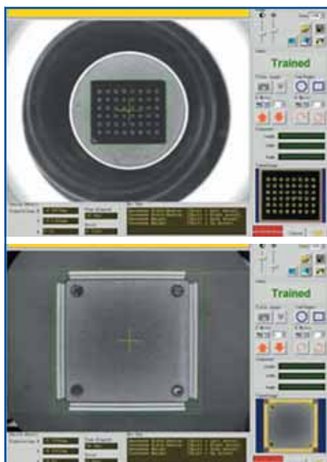
Рис. 4. Вид экрана процедуры обучения распознавания компонентов (в центре — изображение с цифровой видеокамеры, в правом углу в желтой окантовке — распознанные контакты)
