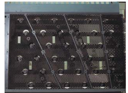
Блок нерастворимого анода, где видны четыре отдельно управляемых сегмента
