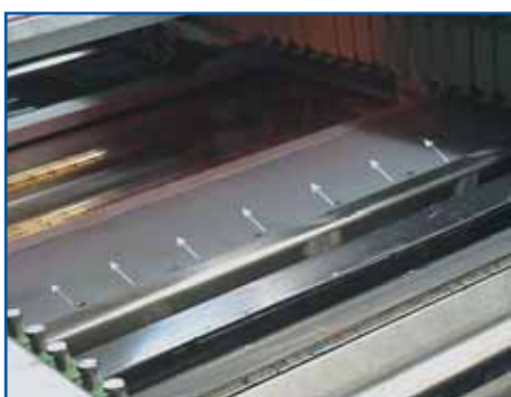
Рис. 9. Специальное сопло сверхточного нагрева
