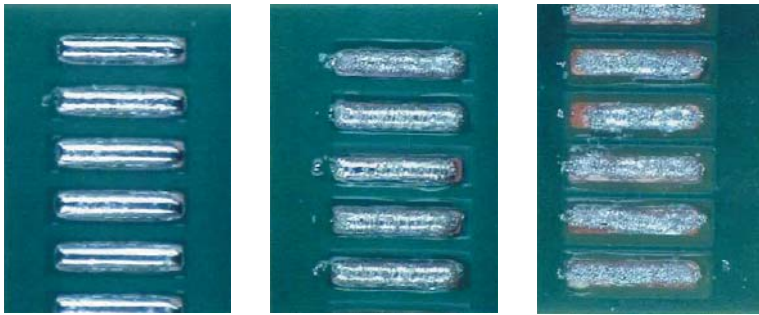
Рис. 1. Увеличение уровня оксидов (слева направо) приводит к спеканию частиц припоя
