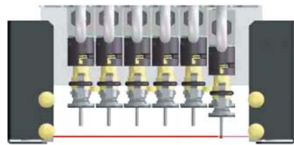
Рис. 7. Измерение толщины компонентов (опция)
