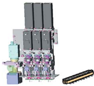
Рис. 6. Установка сквозных разъемов модулем В-типа
