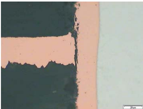
Рис. 9. Дефекты соединений внутренних слоев
