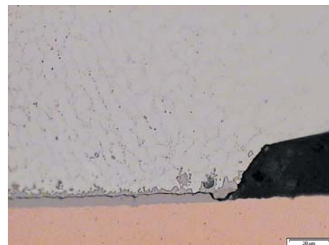
Рис. 6. Образование трещин в паяном соединении компонента BGA
