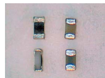
Рис. 13. Резисторы (слева) и конденсаторы (справа) типоразмера 0201
