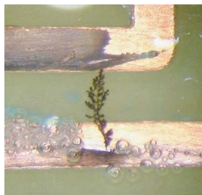
Рис. 2. Дендритная коррозия печатного узла
