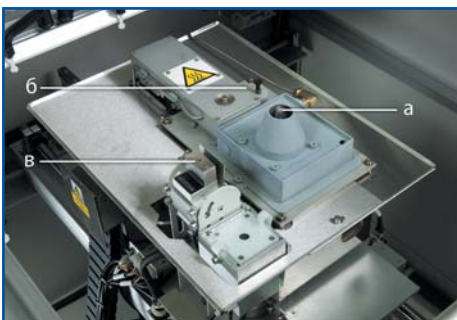
Рис. 4. Подвижная каретка: а) сопло; б) поплавок; в) устройство нанесения флюса
