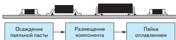
Рис. 1. Односторонняя сборка поверхностного монтажа (ПМ) для компонентов поверхностного монтажа (КПМ), только пайка оплавлением
