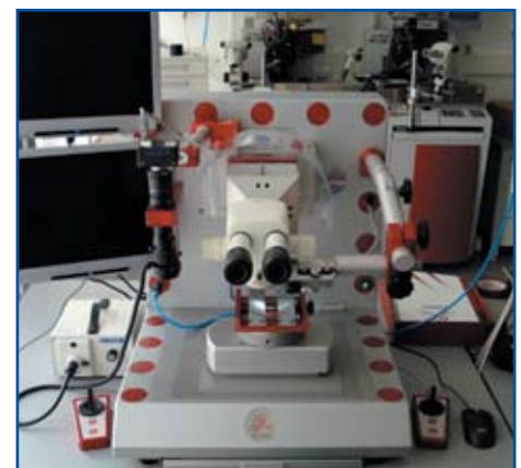
Рис. 4. Конструкция для испытаний «Кондор 150-3», IZM, Берлин
