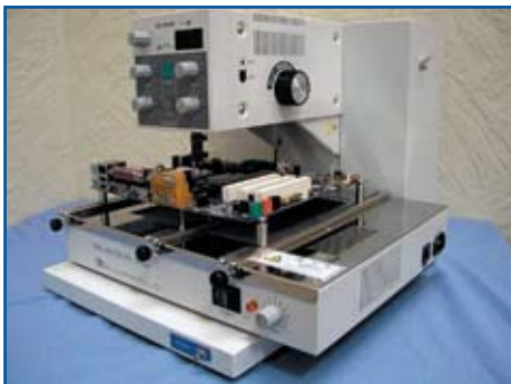
Рис. 2. Управление процессом пайки в ремонтной станции SD-3000
