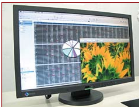
Рис. 2. 23-дюймовый жидкокристаллический монитор FlexScan EV2303W-T фирмы Eizo Nanao с инфракрасным датчиком
