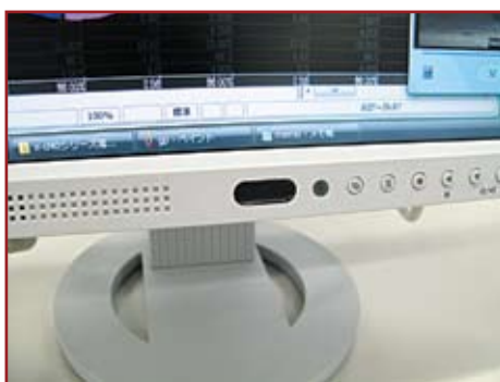
Рис. 3. Инфракрасный датчик на нижнем крае монитора
