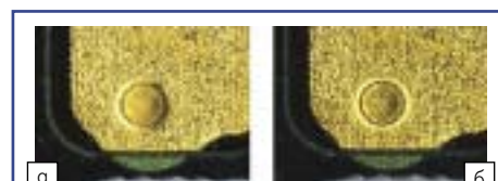
Рис. 5. Изображения: а) с наилучшим разрешением; б) с наилучшей глубиной фокуса
