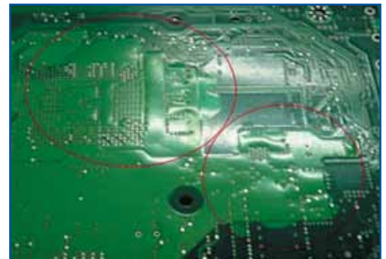
Рис. 1. Отслаивание защитного покрытия
