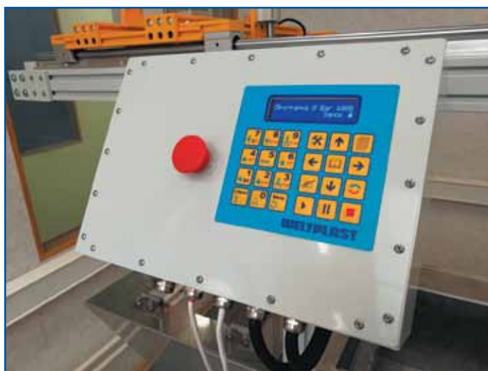
Рис. 3. Интерфейс линии отмывки «Рондо»
