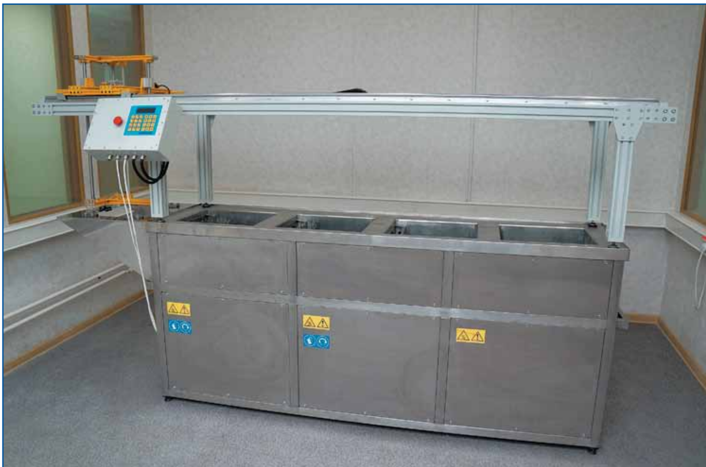
Рис. 2. Роботизированная система ультразвуковой отмывки «Рондо»
