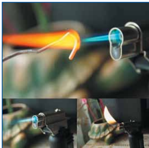
Рис. 1. Благодаря катализатору пламя паяльника не вырывается, а равномерно горит на поверхности керамической решетки и нагревает жало
