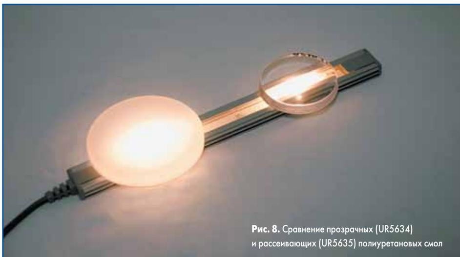
**Рис. 8.** Сравнение прозрачных (UR5634) и рассеивающих (UR5635) полиуретановых смол
