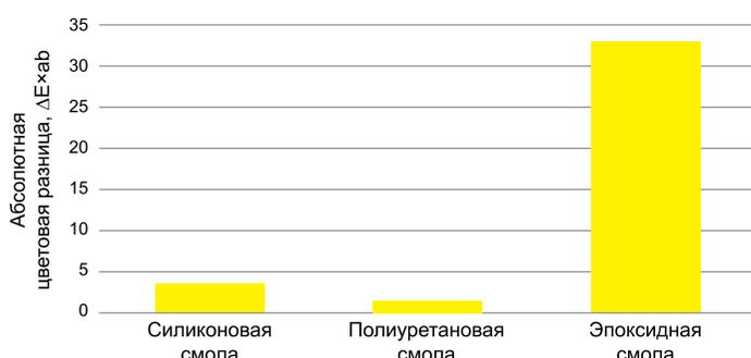
**Рис. 6.** Сравнение стандартного химического состава смол после 1000 ч воздействия УФ-света
