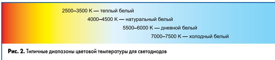
Рис. 2. Типичные диапазоны цветовой температуры для светодиодов
