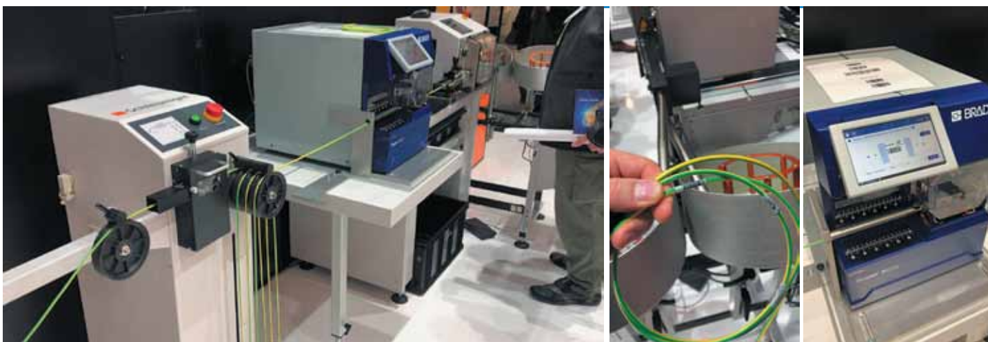
Рис. 5. Встроенная маркировка кабелей на основе установки Brady Wraptor A6500
