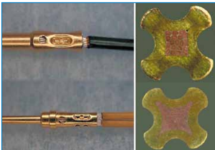
Рис. 5. Вид микрошлифов качественного обжимного соединения (ECSS-Q-ST-70-26C)
