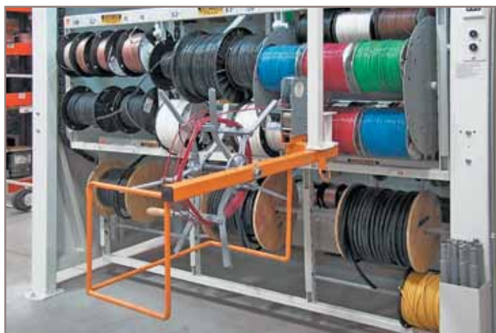
Рис. 3. Пример системы хранения проводов и кабелей с устройством перемотки
