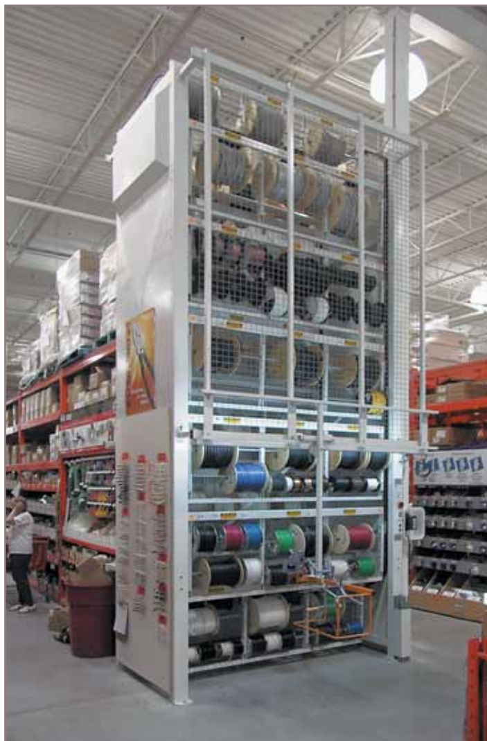
Рис. 2. Автоматизированная складская система карусельного типа WCARVidir
