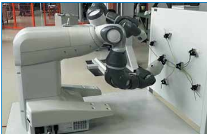
Рис. 7. Коллаборативный робот выполняет раскладку жгута на вертикальном плазме
