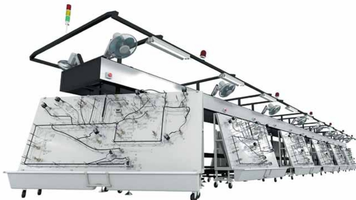
Рис. 6. Автоматическая линия сборки жгутов с плазмами на тележках от компании Schleuniger
