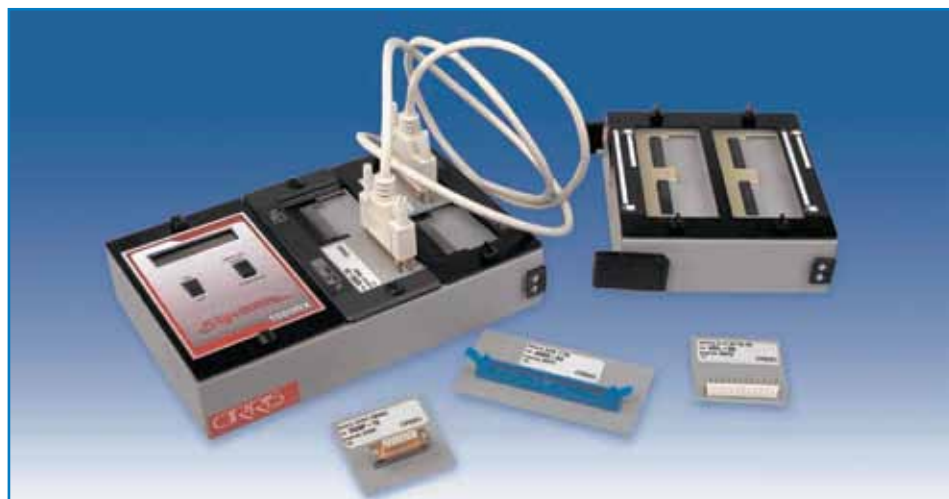
Рис. 2. Низковольтный кабельный тестер Cirris Signature 1000RX: слева — базовый блок; справа — модуль расширения
