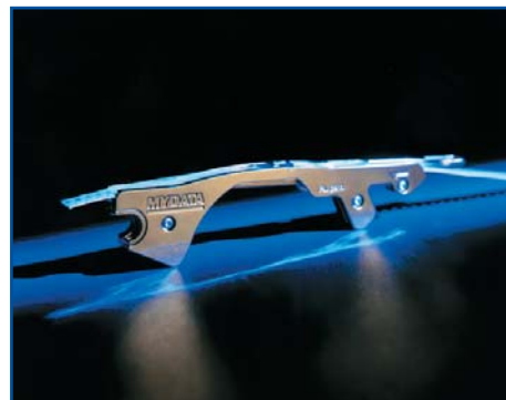
Рис. 3. Питатели типа AGILIS производства компании MYDATA, позволяющие загружать компоненты в течение 10 с
