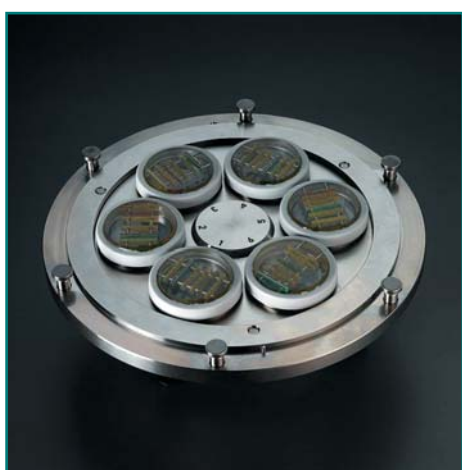
Рис. 5. Держатель образца для автоматической подготовки. ViaHolder (Struers)
