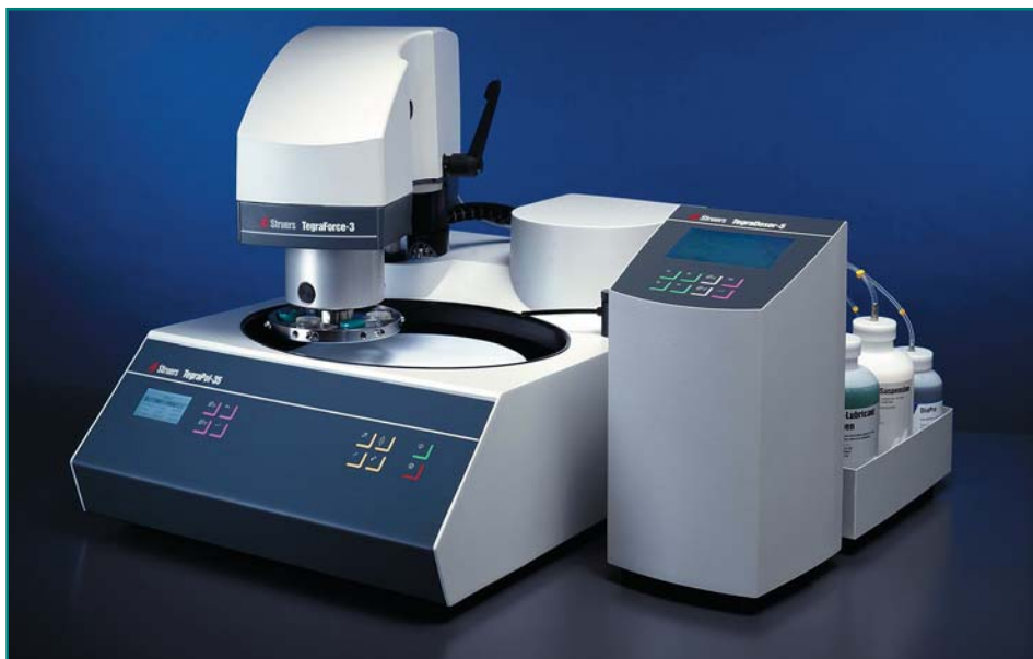
Рис. 7. Автоматический шлифовально-полировальный станок. TegraSystem (Struers)
