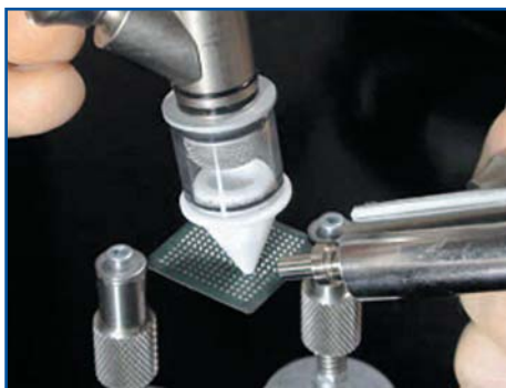
Рис. 26. Расплавление выводов и подъем компонента
