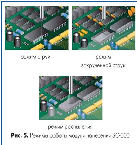
Модуль нанесения покрытий SC-300 идеально подходит для производителей, которые собирают широкую номенклатуру изделий либо которым требуется большой диапазон толщин покрытия. Обладая возможностью нанесения покрытий толщиной 6,4–500 мкм за один проход, модуль SC-300 может наносить широкий спектр материалов на основе растворителей и материалов с вязкостью от 30 до 3500 сП. Более того, нанесения маскирующего покрытия на области ПУ, не подлежащие защите, в большинстве случаев не требуется.
