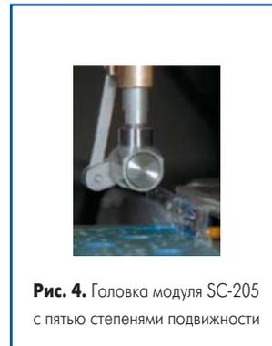
Рис. 4. Головка модуля SC-205 с пятью степенями подвижности
