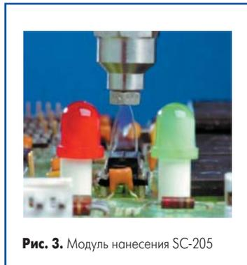
Рис. 3. Модуль нанесения SC-205
