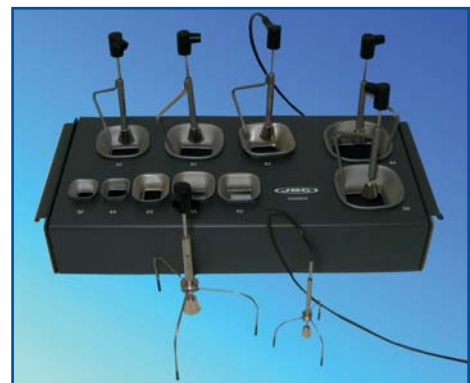
Рис. 6. Комплект теплоотражателей на подставке
