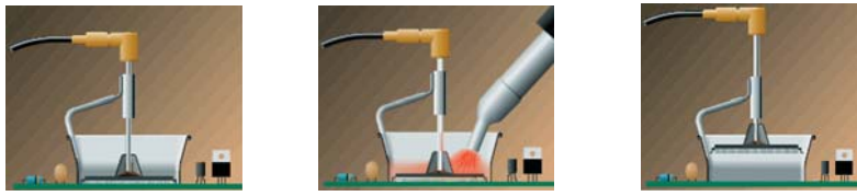
Рис. 2. Процесс демонтажа микросхемы
