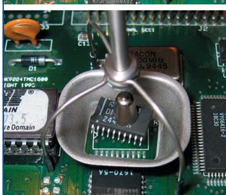
Рис. 4. Процесс демонтажа SOIC20
