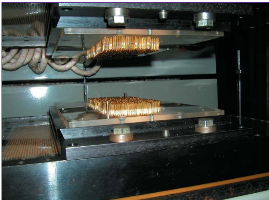
Рис. 4. Внешний вид соединительного устройства (контактного поля) матричного тестера АСПК ПП
