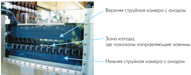
Рис. 6. Вид сбоку идеализированной ячейки для горизонтального осаждения, используемой в целях оптимизации потока раствора
