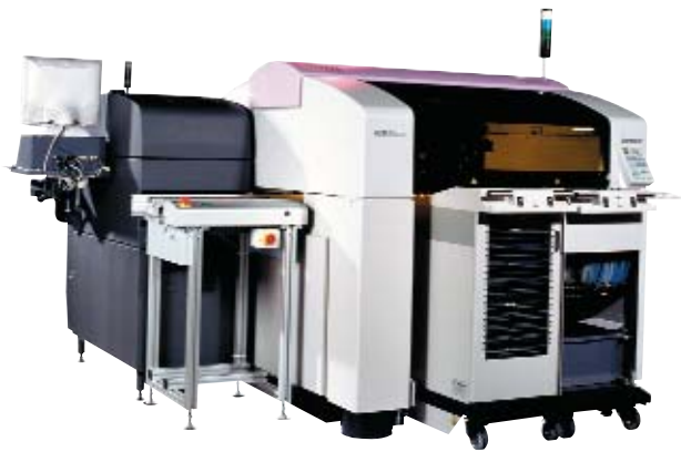
Рис. 5. Высокоточный сверхгибкий автомат установки компонентов ACM Micro
