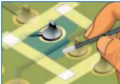
Рис. 4. Удаление покрытия методом растворения. Стандарт IPC-7711/21A
