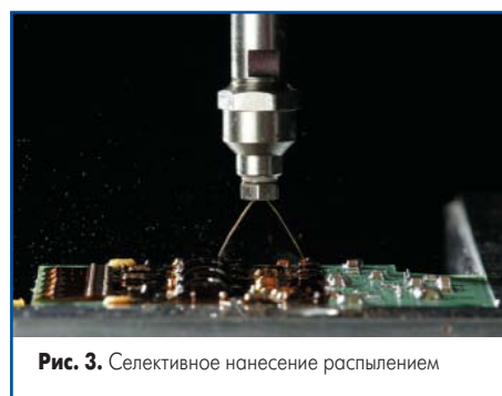
Рис. 2. Нанесение покрытия распылением
