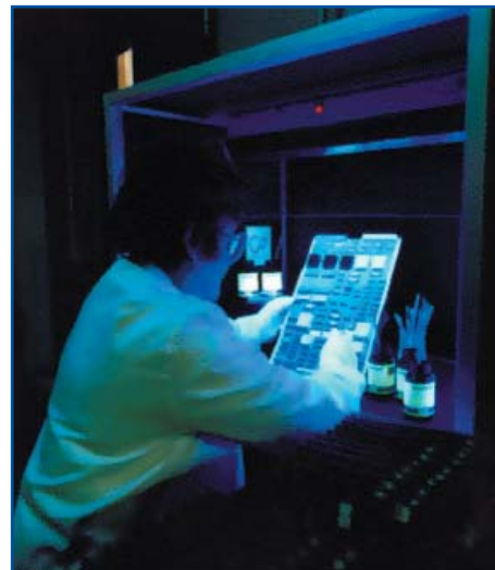
Рис. 5. Контроль качества покрытия в УФ-свете
