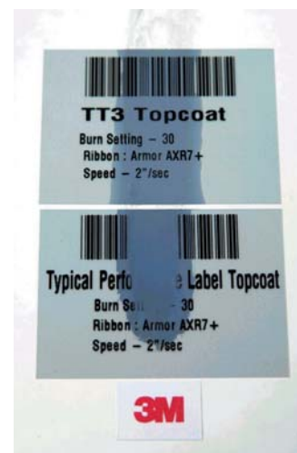
Рис. 9. Стойкость верхней этикетки к воздействию тормозной жидкости обеспечивает покрытие ТТ3
