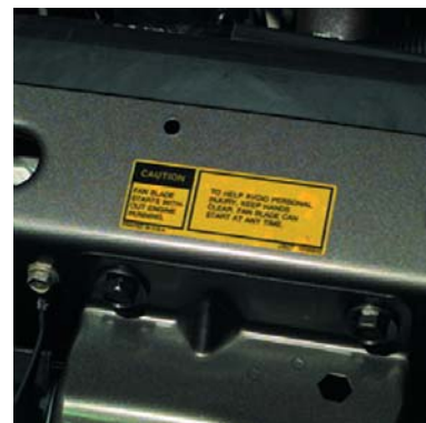
Рис. 10. Этикетки с покрытием ТТ3 рекомендуется использовать для маркировки изделий, эксплуатирующихся в агрессивных условиях
