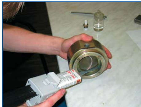
Рис. 8. Благодаря удобному пистолету и носику клей можно аккуратно наносить в труднодоступных местах
