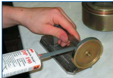
Рис. 7. Толщину нанесения клея можно регулировать путем усечения носика до нужного диаметра
