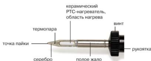
Рис. 8. Паяльное жало ERSA 612 в разрезе
