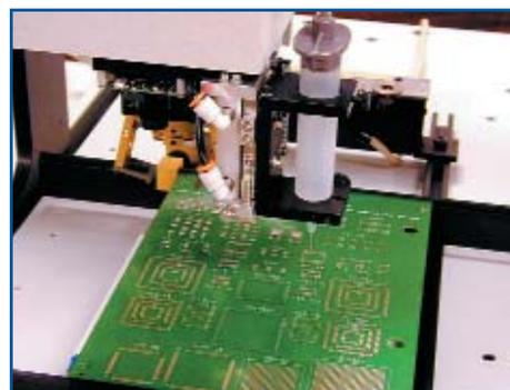
Рис. 3. Дозатор
