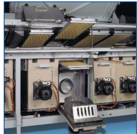
Рис. 14. Выдвижные нижние нагреватели, вентиляторы и модули Multijet
