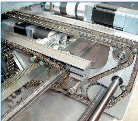
Рис. 10. Конвейерная система печей серии Hotflow 2
