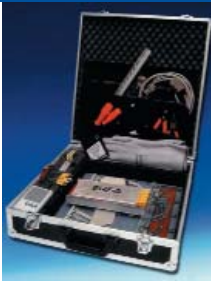
Рис. 17. Устройство измерения температурных профилей Sensor Shuttle
