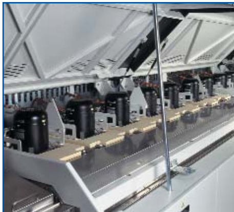
Рис. 13. Моментальный доступ к верхним нагревательным и охлаждающим модулям
