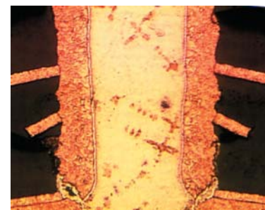
Рис. 14. Металлизация отверстия, разрушенная пайкой бессвинцовым припоем. Пластичность меди 4%
