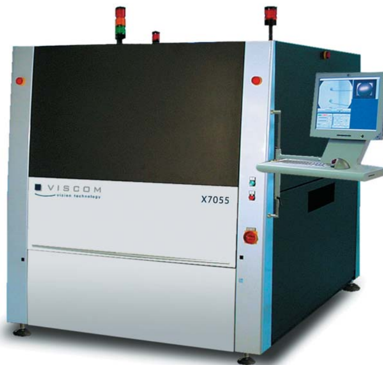
Рис. 1. X7055 — сочетание оптического и рентгеновского контроля в одном устройстве
