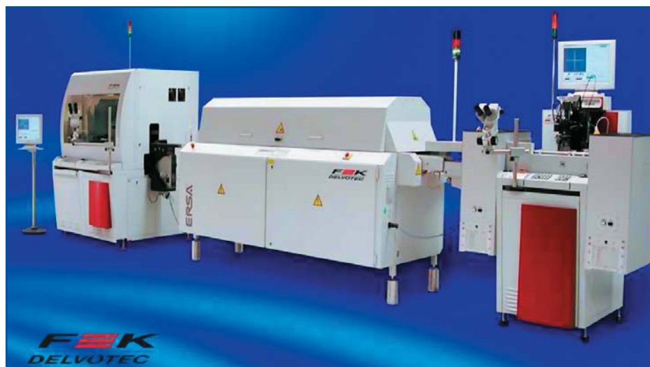
Рис. 8. Автоматическая линия сборки по технологии COB
