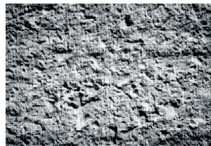
Рис. 2. Топография поверхности, полученной при струйной обработке поверхности частицами пемзы или оксида алюминия
