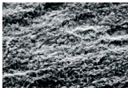
Рис. 4. Медная поверхность после процесса микро травления
