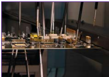
Рис. 9. Тестирование соединений между разъемом и микросхемой
