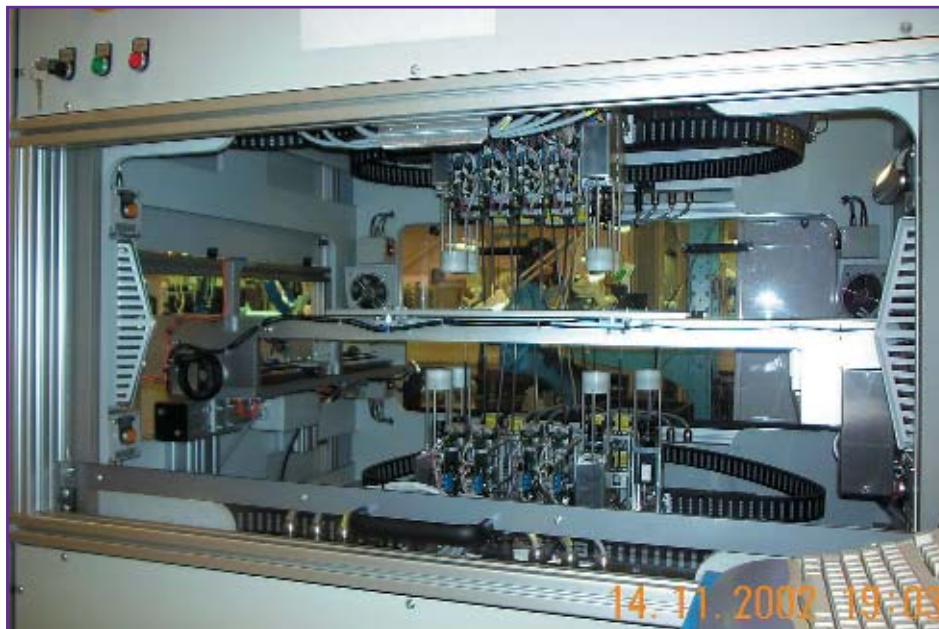
Рис. 11. Общий вид тестера Scorpion Technologies с «летающими зондами»
